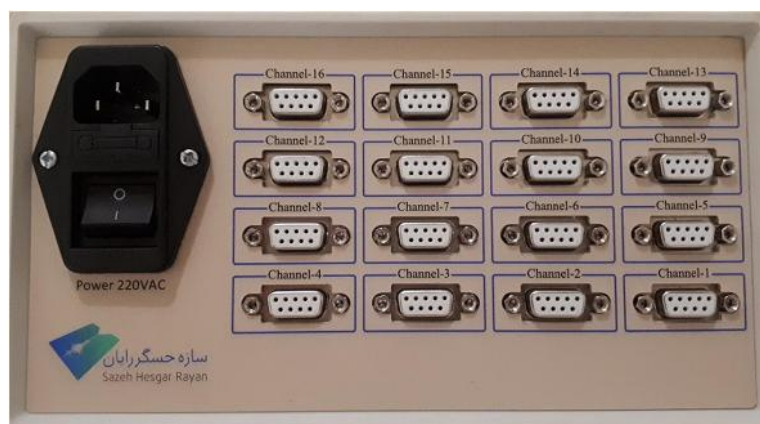
شکل (۳): نمای پشت سیستم اندازه‌گیری شانزده کانالی UMS-16
